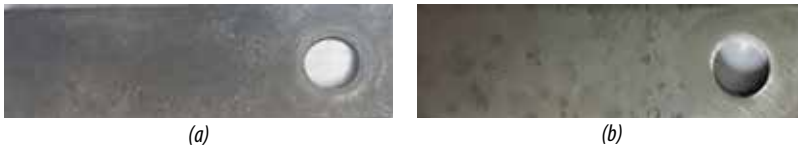
Hình 8. Hình ảnh mẫu bị ăn mòn trong môi trường trong pha khí điều kiện tĩnh (a) và điều kiện động (b).
